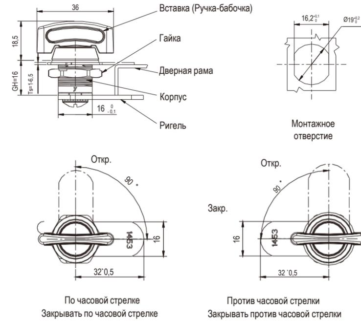
Корпус и вставка замка из цинка ЛПД; с черным напылением; ригель из оцинкованной стали
