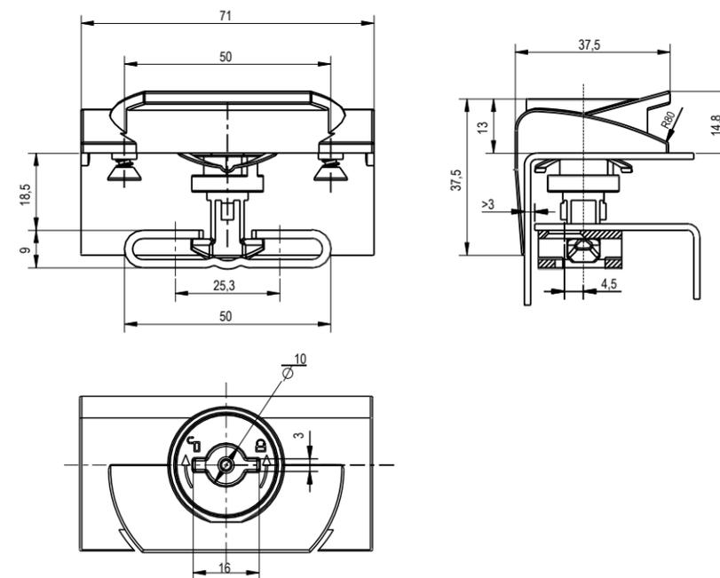
Корпус замка - полиамид, вставка из цинка ЛПД, крепежные детали из оцинкованной стали
