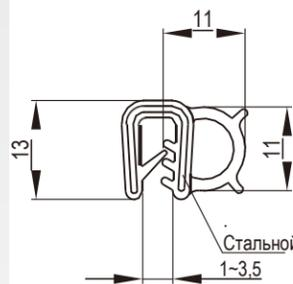
Стальной пружинный каркас
