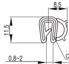
Стальной пружинный каркас
