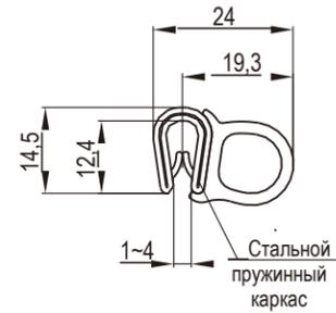
Стальной пружинный каркас
