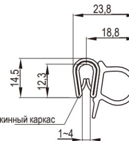
Стальной пружинный каркас
