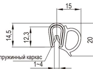
Стальной пружинный каркас
