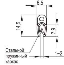
Стальной пружинный каркас
