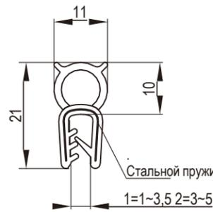
Стальной пружинный каркас
