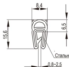
Стальной пружинный каркас
