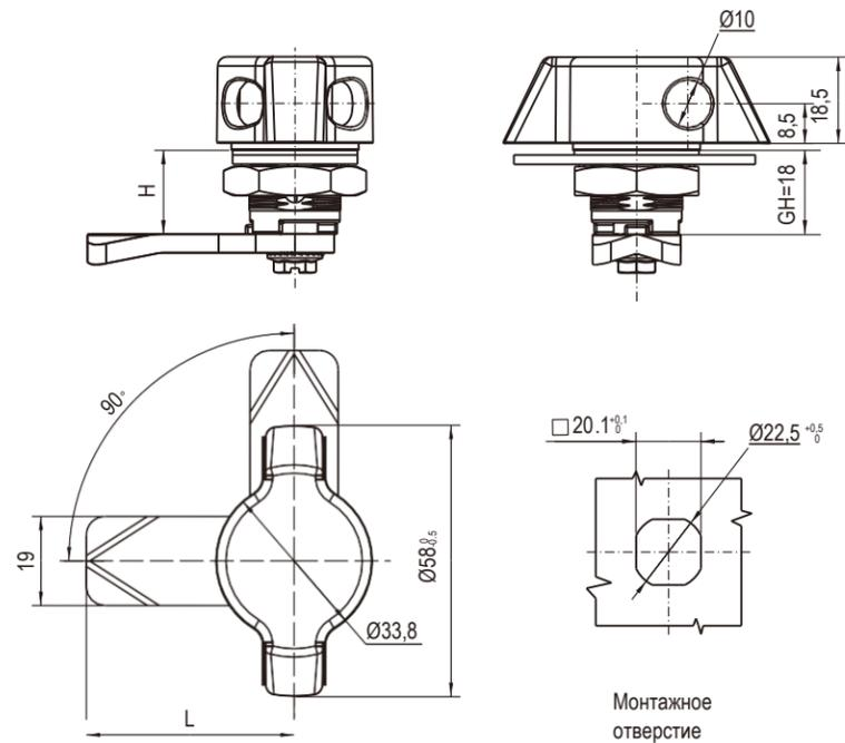
Корпус и ручка замка из цинка ЛПД; с черным напылением или хромированные (глянец); ригель из оцинкованной стали
