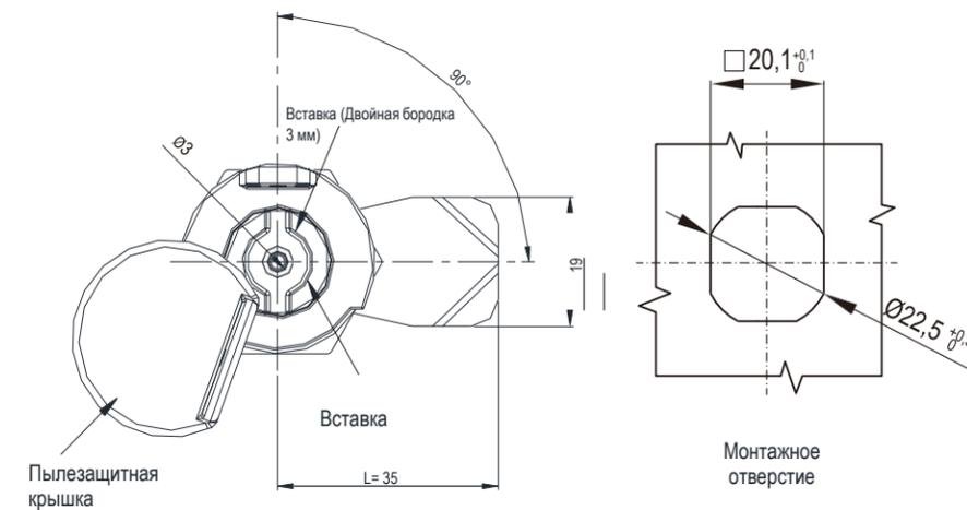
Корпус и цилиндр замка из цинка ЛПД; с черным напылением или хромированные; ригель из оцинкованной стали
