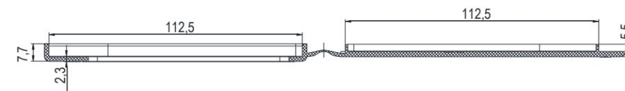
При использовании пылезащитной крышки толщина дверной панели увеличивается на 2,3 мм
