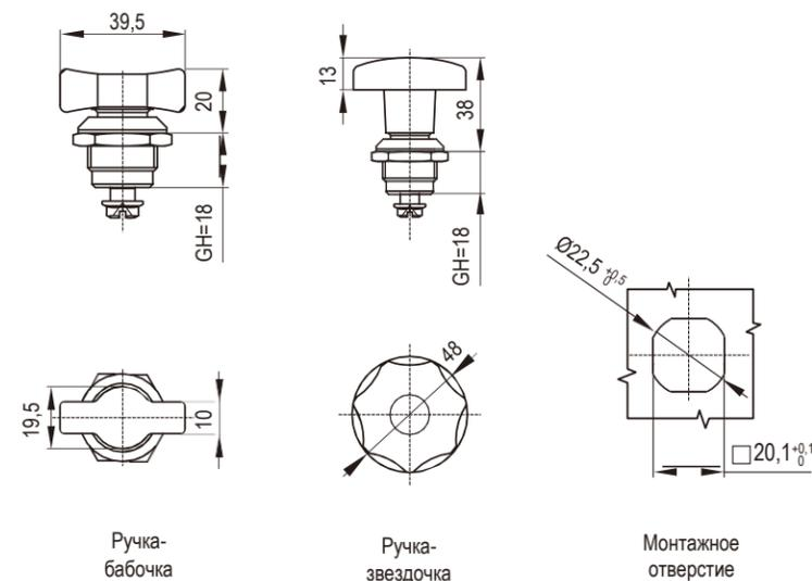
Корпус и ручка замка из цинка ЛПД; с черным напылением или хромированные; ригель из оцинкованной стали
