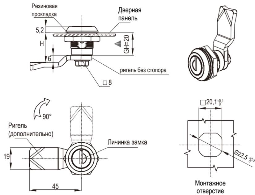
Корпус замка из цинка ЛПД; с черным напылением или хромированный; ригель из оцинкованной стали
