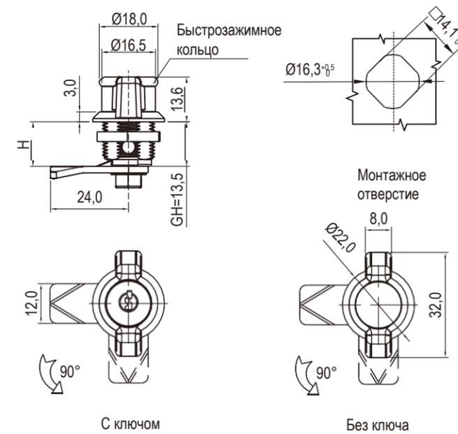
Корпус и ручка замка из цинка ЛПД; с черным напылением или хромированные; ригель из оцинкованной стали
