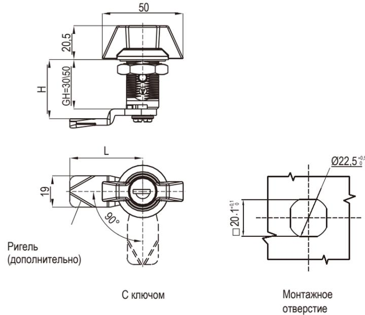
Корпус и ручка замка из цинка ЛПД; с черным напылением или хромированные; ригель из оцинкованной стали
