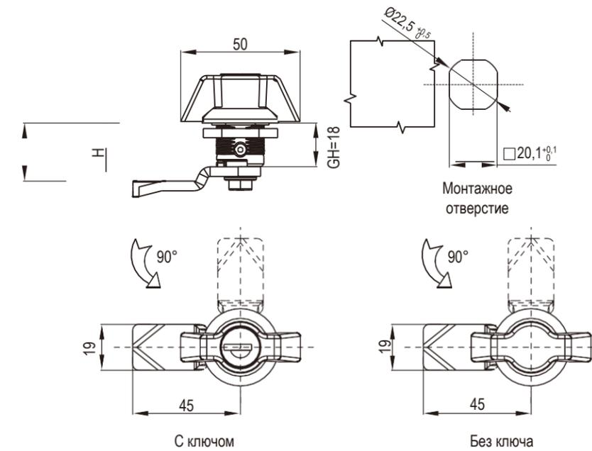
Корпус и ручка замка из цинка ЛПД; с черным напылением или хромированные; ригель из оцинкованной стали
