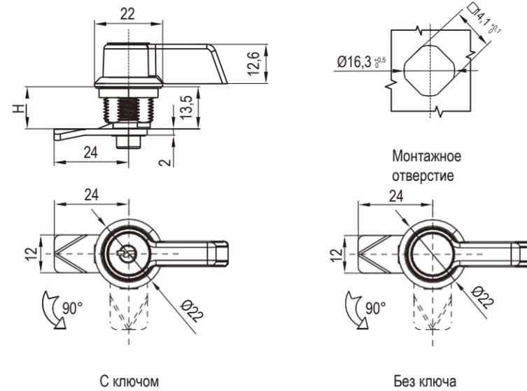
Корпус и ручка замка из цинка ЛПД; с черным напылением или хромированные; ригель из оцинкованной стали
