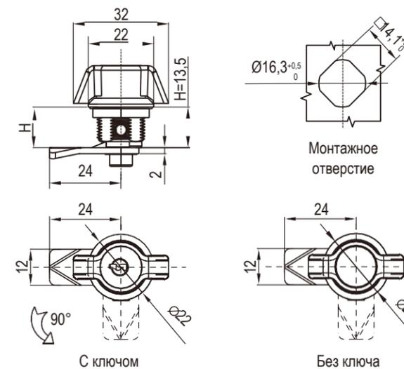
Корпус и ручка замка из цинка ЛПД; с черным напылением или хромированные; ригель из оцинкованной стали
